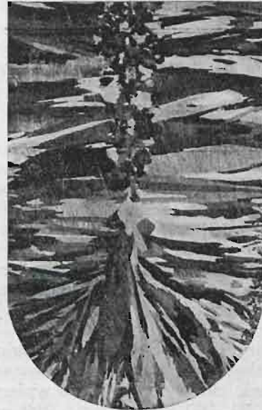
Rys. 48. Wielk. prawie rzec. Układ igielkowy kryształów w przecie z brązu aluminjowego, z krawędziami zaokrąglonymi. Wytraw. nadsiaczanem amonu 1:10.
