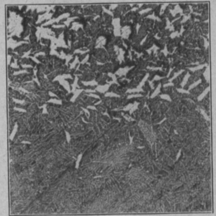
Abb. 13. Geseigertes Einheitsmetall, geätzt mit heißer H_2SO_4 , 1:1. Lineare Vergrößerung 50 ×.
