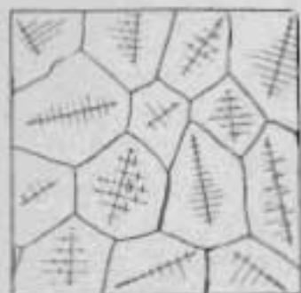
Abb. 28. Dendritischer Kristallaufbau nach Desch (schematisch).
