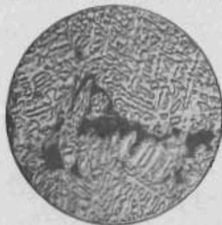
Abb. 22. Dendritische Hohlräume im Rotguss. Geätzt mit Ammoniak. Lösung: Feig. 130.
