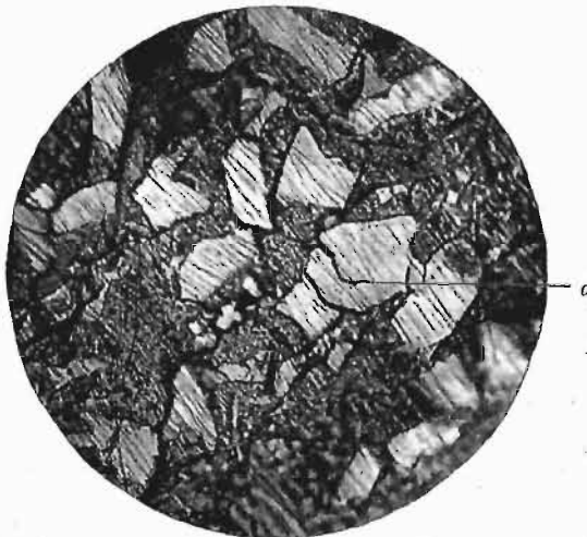
Abb. 62. Einheitsmetall, trotz Bruchbildung (a) Gleitliniensystem nicht sichtbar. Lineare Vergr. \approx 1000 .
