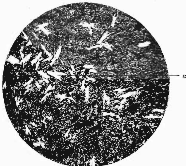
Abb. 15. Verbranntes Einheitsmetall. Geätzt mit Schwefelsäure 1:1. Lineare Vergr. = 250.
