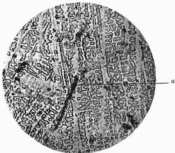
Abb. 7. Probestück, wie bei Abb. 6, aber geätzt. Ätzpoliert mit Ammoniakwattebausch. Lineare Vergr. = 50.
