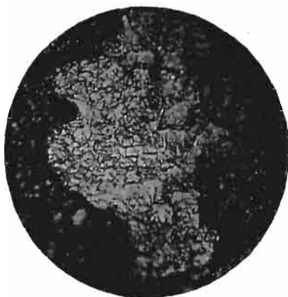
Abb. 56. Zinnkristall mit Ätzfiguren. Geätzt mit Salzsäure-Kaliumchlorat. (Lin. Vgr. 210.)
