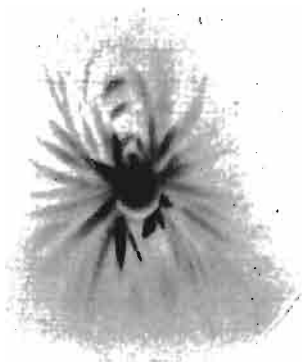
Abb. 199. Laue-Diagramm des selben Gipskristalls nach der Biegebeanspruchung.
