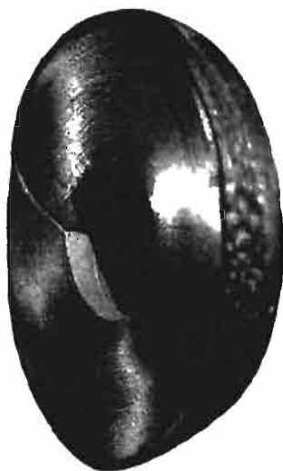
Abb. 247. Ringförmig gebogener Aluminium-Einkristall; Schnitt parallel zur Längsachse des Stabes. Geätzt mit Flußsäure-Salzsäure. (Etwa natürl. Größe.)
