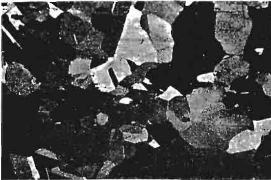
Abb. 94. \alpha -Messing, rekristallisiert. Die einzelnen Kristalle sind an den Helligkeitsunterschieden erkennbar. Geätzt mit Ammoniumpersulfat 1 : 10. (Lin. Vgr. 0,9.)
