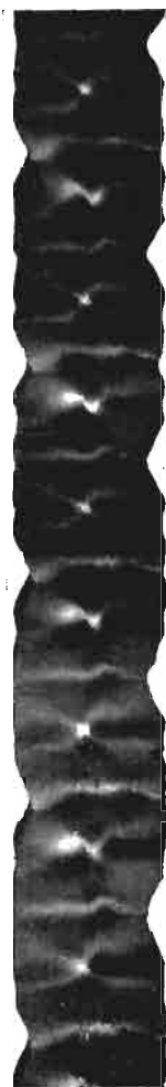
Abb. 244. Längsschnitt desselben Stabes. Geätzt mit Flußsäure-Salzsäure. (Etwa natürl. Größe.)
