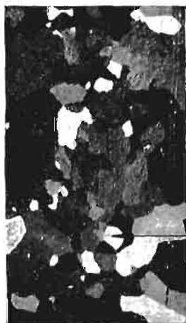
Abb. 151. Das in Abb. 150 dargestellte Metallstück nach hundertstündigem Erhitzen bei 200°. Geätzt mit Salzsäure-Kaliumchlorat. (Lin. Vgr. 5.)
