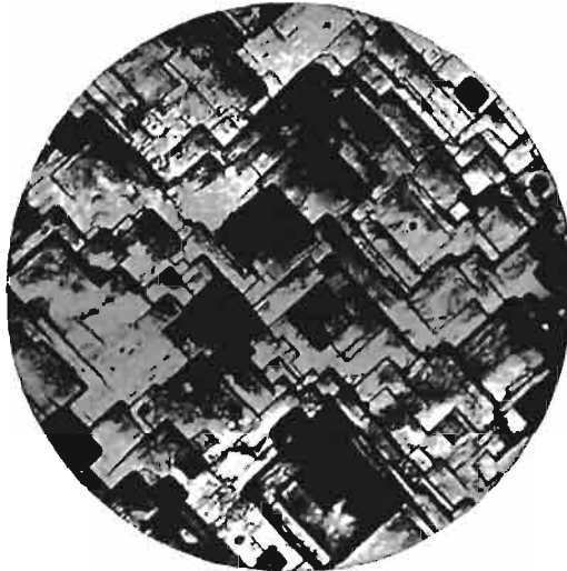
Abb. 163. Ätzfiguren an einem Kristall der in Abb. 162 dargestellten Probe. Tiefgeätzt mit Kupferammoniumchlorid 1 : 12 (nach Harnecker u. Rassow). (Lin. Vgr. 700.)
