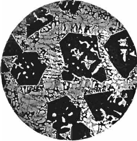
Abb. 70. Idiomorphe Kristalle in einer Zinn-Zinn-Magnesiumlegierung. Geätzt durch Verdunsten eines Tropfens Salzsäure auf der Schlißfläche. (Lin. Vgr. 180.)
