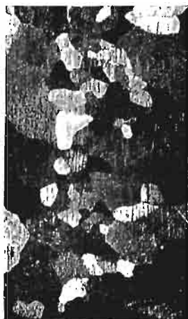
Abb. 150. Gefüge von gegossenem Zinn mit künstlicher Schliffläche vor dem Glühen. Geätzt mit Salzsäure-Kaliumchlorat. (Lin. Vgr. 5.)
