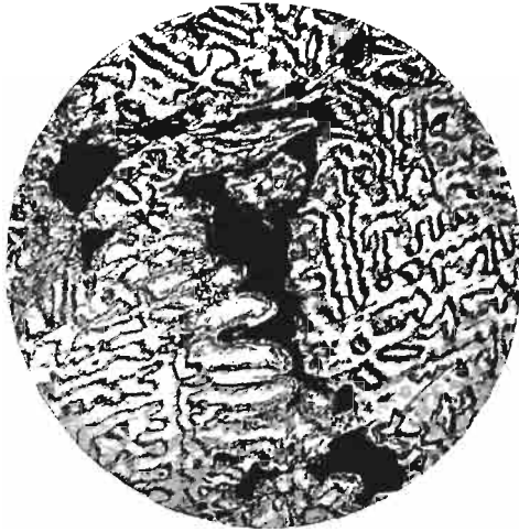
Abb. 78. Dendritische Hohlräume in Rotguß. Geätzt mit Ammoniak-Wattebausch. (Lin. Vgr. 150.)
