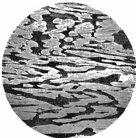
Abb. 58. \alpha - \beta -Messing, geätzt in warmer Schwefelsäure 1:1, \alpha -Kristalle fast unverändert, \beta -Kristalle infolge elektrolytischer Selbstkorrosion gerötet. (Lin. Vgr. 210.)
