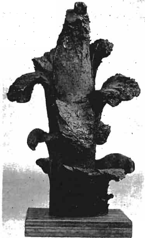
Abb. 294. Preßbarren aus \alpha -Messing, der beim Herausnehmen aus dem Rezipienten infolge innerer Spannungen aufblätterte. (Lin. Vgr. 0,17.)
