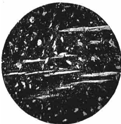
Abb. 59. Mangan-Messing, stark angelassen, \alpha -Kristalle fast unverändert, \beta -Kristalle charakteristisch oxydiert. (Lin. Vgr. 210.)
