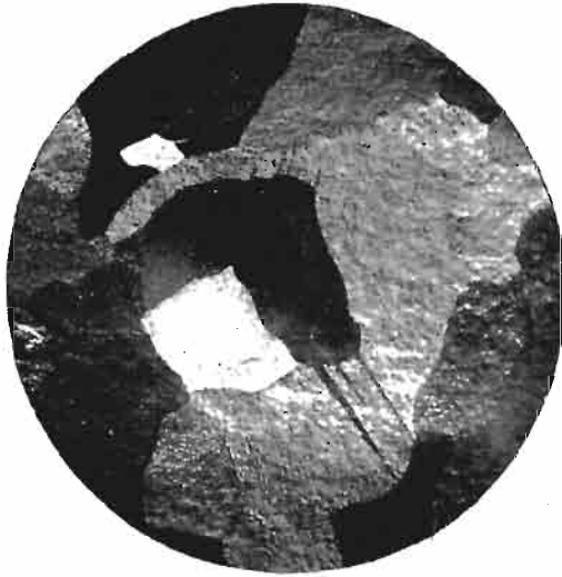
Abb. 157. Derselbe Zinnkristall nach stattgchabter Rekristallisation bei 215^{\circ} , 30 Minuten. Ausbildung mehrerer neuer Kristalle. Geätzt mit Salzsäure-Kaliumchlorat. (Lin. Vgr. 5.)
