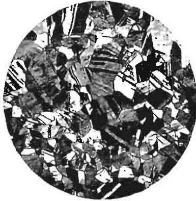
Abb. 147. Rekristallisationszwillinge in \alpha -Aluminiumbronze. Ätzpoliert mit ammoniakgetränktem Wattebausch. (Lin. Vgr. 210.)
