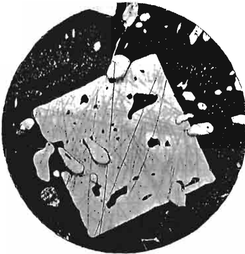
Abb. 71. Idiomorphe Kristalle in einer Zinn-Antimon-Kupferlegierung. Geätzt durch Verdunsten eines Tropfens Salzsäure auf der Schlißfläche. (Lin. Vgr. 180.)
