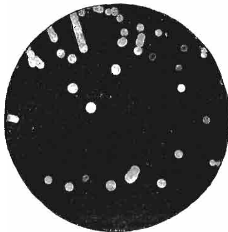
Abb. 63. Kristallisationskerne in Betol (nach Tammann).
