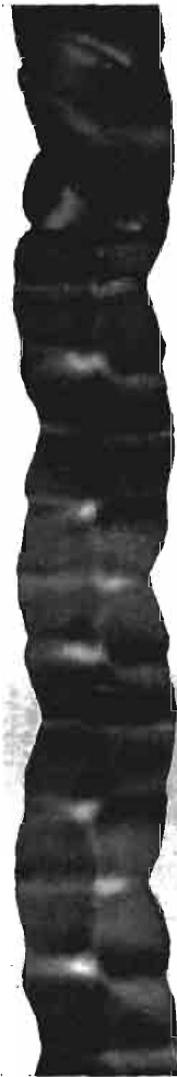
Abb. 241. Längsschnitt desselben Stabes. Geätzt mit Flußsäure-Salzsäure. (Etwa natürl. Größe.)
