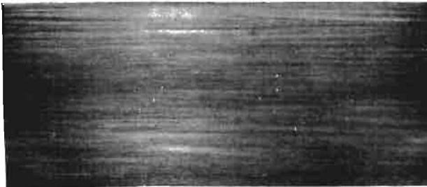
Abb. 259. Dieselbe Platte stärker kaltgewalzt (Höhenabnahme 99%). Die Helligkeitsunterschiede der einzelnen Kristalle sind fast völlig verwischt. Ätzung Flußsäure-Salzsäure. (Lin. Vgr. 1,3.)
