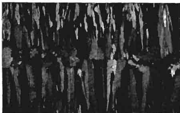
Abb. 133. Nadeliges Gußgefüge von Aluminiumbronze mit 8% Aluminium. Geätzt mit Ammoniumpersulfat 1 : 10. (Lin. Vgr. 0,75.)
