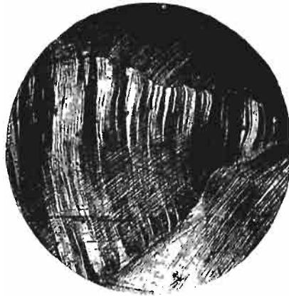
Abb. 107. Gekrümmte und durcheinander gewirbelte Streifungen auf einem Aluminiumbronze- \alpha -Kristall. Ätzpoliert mit ammoniakgetränktem Wattebausch. (Lin. Vgr. 210.)
