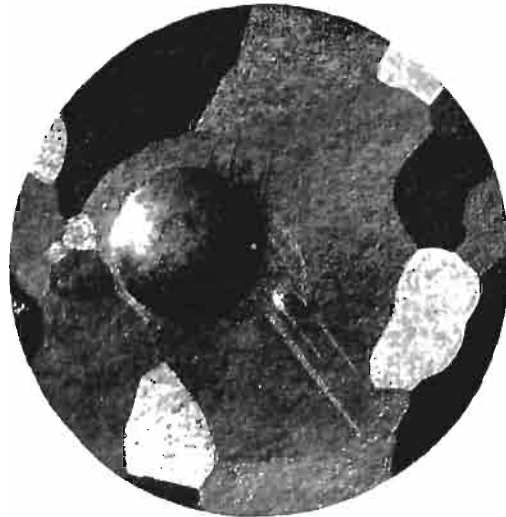
Abb. 156. Zinnkristall, mit einem großen Kugeleindruck versehen, vor der Rekristallisation. Geätzt mit Salzsäure-Kaliumchlorat. (Lin. Vgr. 5.)
