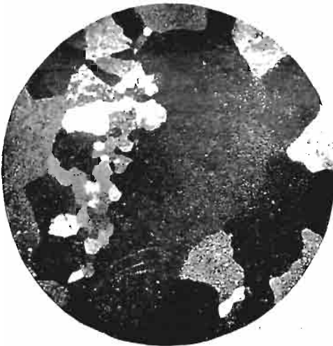
Abb. 149. Das in Abb. 148 dargestellte Metallstück nach einmonatigem Glühen bei 210°. Geätzt mit Salzsäure-Kaliumchlorat. (Lin. Vgr. 6.)
