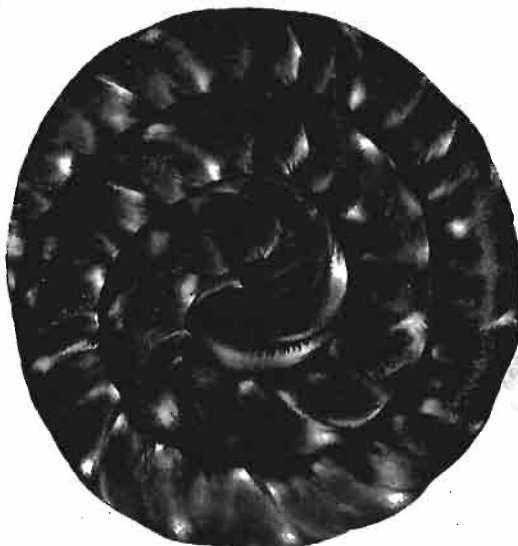
Abb. 250. Verdrehter und darauf spiralartig gebogener Aluminium-Einkristall. (Etwa natürl. Größe.)
