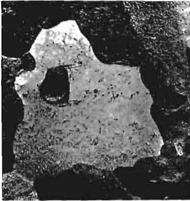
Abb. 154. Derselbe Kugeleindruck nach einer weiteren Glühung von 30 Minuten bei 220°. Fortschreiten der Rekristallisation. Geätzt mit Salzsäure-Kaliumchlorat. (Lin. Vgr. 4,5.)
