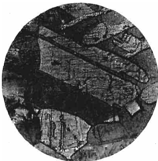
Abb. 164. Gefüge einer rekristallisierten Kupferprobe. Geätzt mit Ammoniumpersulfat 1 : 10. (Lin. Vgr. 75.)
