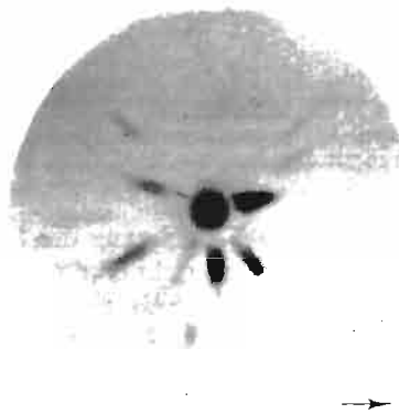
Abb. 214. Laue-Diagramm desselben Kristalls nach einer Querschnittsabnahme von 50%.
