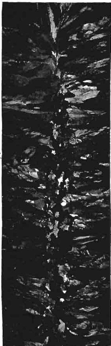
Abb. 100. Aluminiumbronzebarren nach einer Querschnittsabnahme von 5%. Geätzt mit Ammoniumpersulfat 1:10.. (Lin. Vgr. 0,9).
