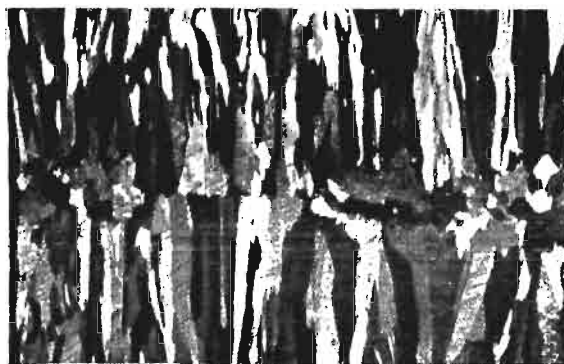
Abb. 92. Aluminiumbronze, Gußgefüge. Die einzelnen Kristalle werden durch Helligkeitsunterschiede angezeigt. Geätzt mit Ammoniumpersulfat 1 : 10. (Lin. Vgr. 0,9.)
