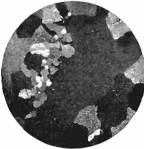
Abb. 148. Zinnprobe mit natürlicher Gußoberfläche vor dem Glühen. Geätzt mit Salzsäure-Kaliumchlorat. (Lin. Vgr. 6.)
