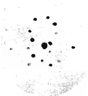
Abb. 229. Laue-Diagramm eines fast unversehrten Aluminium-Einkristalls.
