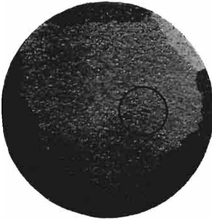
Abb. 211. Aluminium-Einkristall mit eingezeichnetem Durchstrahlungsfeld. Geätzt mit Flußsäure-Salzsäure. (Lin. Vgr. 4,5.)
