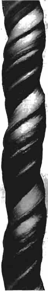
Abb. 239. Verdrehter Aluminium-Einkristall (Rundstab). (Etwa natürl. Größe.)
