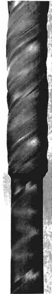
Abb. 245. Verdrehter Aluminium-Einkristall, linke Hälfte nach dem Abdrehen. Geätzt mit Flußsäure-Salzsäure. (Etwa natürl. Größe.)
