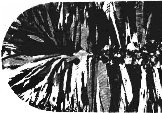
Abb. 91. Nadel-Anordnung der Kristalle in einem Aluminiumbronzebarren mit abgerundeten Kanten. Geätzt mit Ammoniumpersulfat 1 : 10. (Lin. Vgr. 0,75.)
