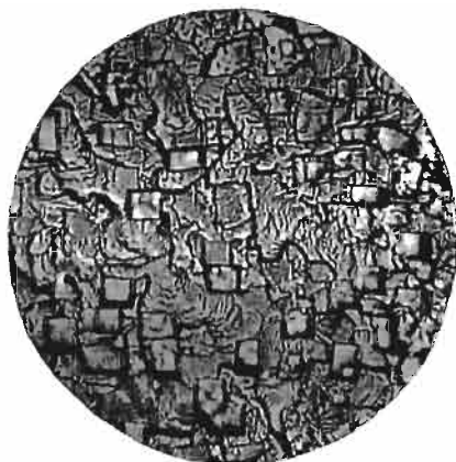
Abb. 57. Aluminiumkristall mit Ätzfiguren. Geätzt mit Flußsäure-Salzsäure. (Lin. Vgr. 1000.)
