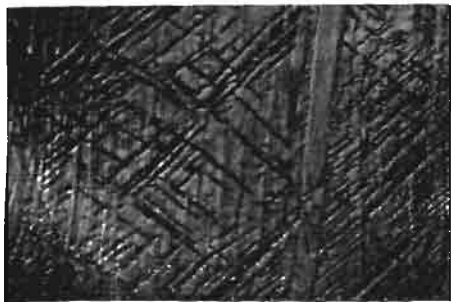
Abb. 102. Innerkristalline Linienscha­ren (Aluminiumbronze- \alpha -Kristall), rautenartige Anordnung der Linien. Ätzpoliert mit (ammoniakgetr. Wattebausch. (Lin. Vgr. 350 )
