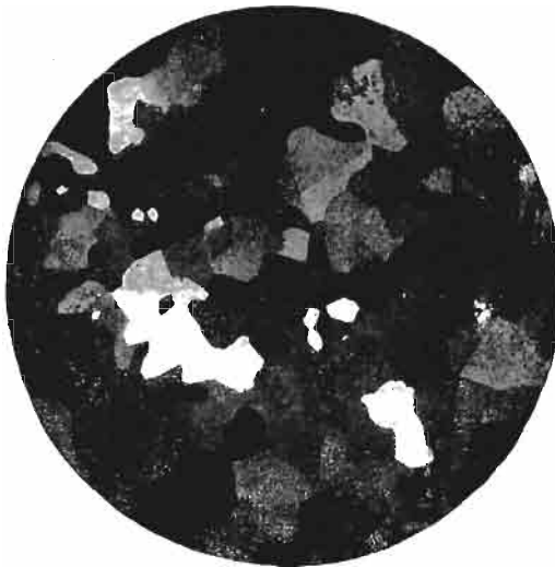
Abb. 42. Kristallfelderätzung; Gußblei, Geätzt in Essigsäure-Wasserstoff-superoxyd. (Lin. Vgr. 4.)
