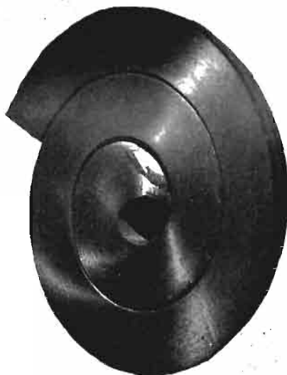
Abb. 248. Spiralartig gebogener Aluminium-Einkristall; Schnitt parallel zur Längsachse des Stabes. Geätzt mit Flußsäure-Salzsäure. (Etwa natürl. Größe.)
