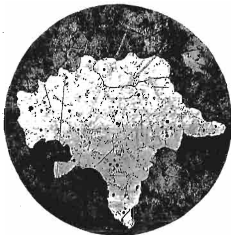
Abb. 67. Allotriomorphe Haufwerkskristalle von Kupfer in uneingeformtem Guß. Ätzpoliert mit ammoniakgetränktem Wattebausch. (Lin. Vgr. 40.)
