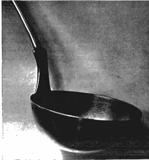
Abb. 77. Dendritische Kristallausbildung an der Oberfläche eines Löffels, ungeätzt. ( \frac{1}{2} nat. Gr.)
