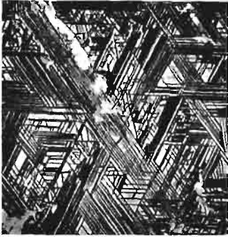
Abb. 52. Ätzgefüge eines Gold-Magnesium-Mischkristalls (nach Urasow). Geätzt mit Bromsalzsäure. (Lin. Vgr. 100.)
