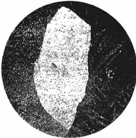
Abb. 124. Das eigentliche Innengefüge des in Abb. 122 und 123 dargestellten Metallstückes nach dem Abbrennen der vorgelagerten rekristallisierten Kristallschichten in Salpetersäure. Nachgeätzt mit Salzsäure-Kaliumchlorat. (Lin. Vgr. 48.)
