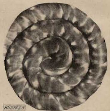
Abb. 7. Spiralartig gebogener Aluminium-Einkristall. Schnitt parallel zur Längsachse des Stabes. Geätzt mit Flußsäure-Salzsäure; etwa nat. Größe.
