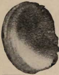
Abb. 6. Verdrehter Aluminium-Einkristallstab, Querschnitt. Geätzt mit Flußsäure-Salzsäure; etwa nat. Größe.
