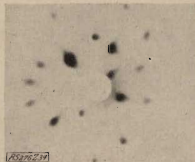
← Abb. 34. Lauebild des unteren zurückgedrehten Teiles, ähnlich dem von völlig unbeanspruchten Kristallen, da die Raumgitterstörungen bis zu einem gewissen Grade wieder rückgängig gemacht wurden.
