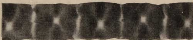
Abb. 4. Verdrehter Aluminium-Einkristallstab, Längsschnitt. Geätzt mit Flußsäure-Salzsäure; etwa nat. Größe.
