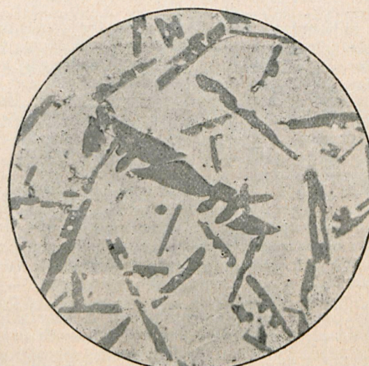
Fig. 5. — Lin. Vergr. 210. AlSb-Krystalle in einer Aluminiumzinnantimonlegierung. Ungeätzt.
