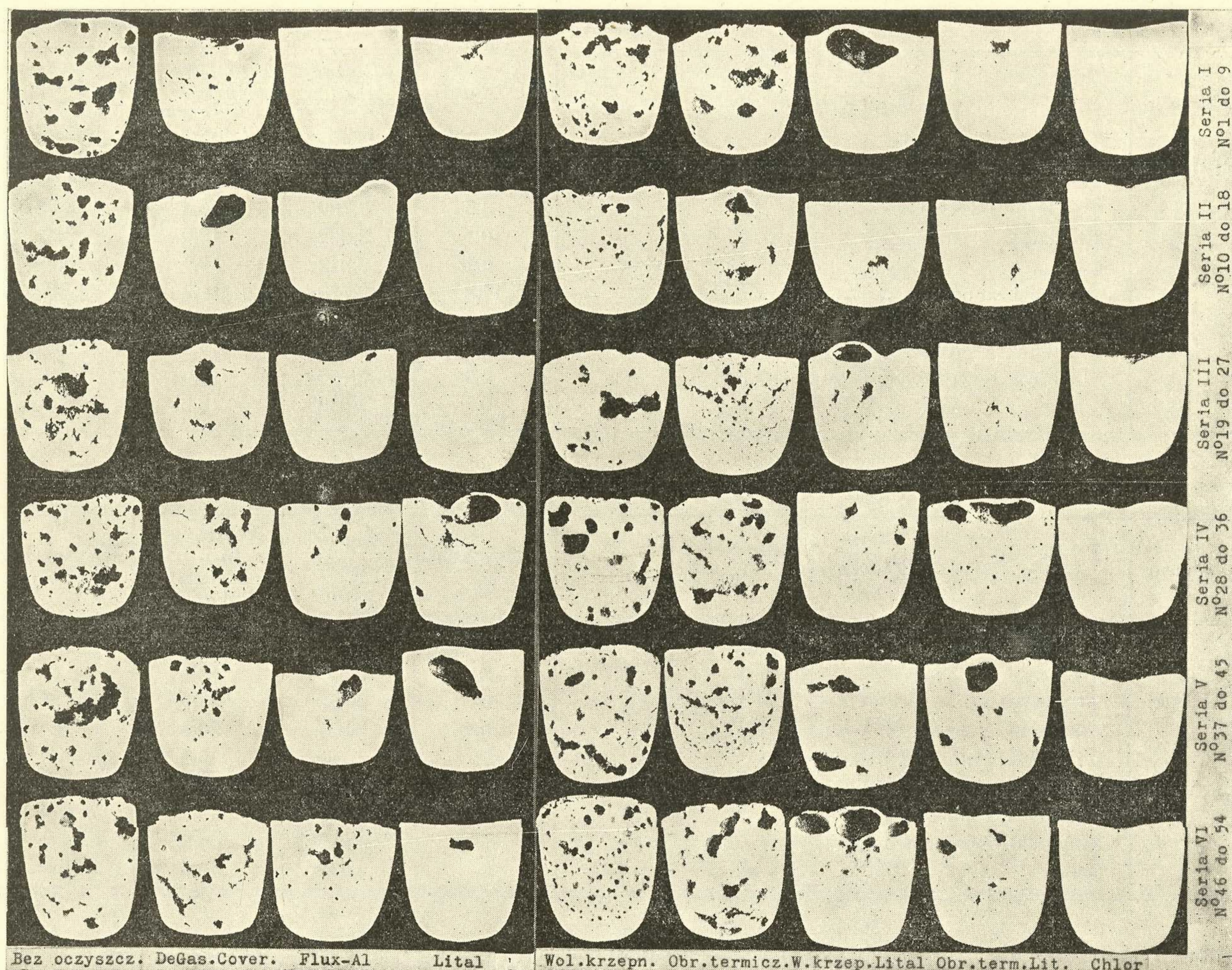
Rys. 1. Przekroje osiowe wlewków rafinowanych różnymi metodami.
