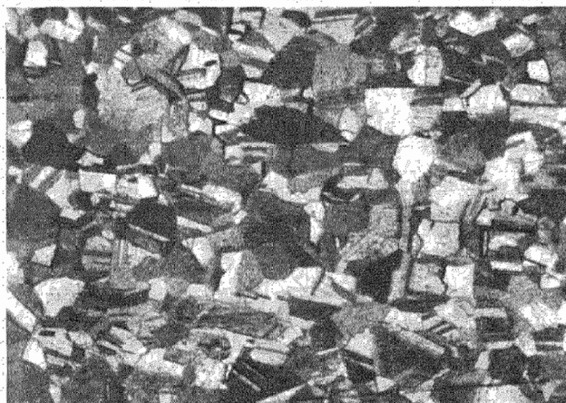
Abb. 12. Gefüge der Al-Bronze mit 5 % Al, Höhenabnahme 87,5 %, gegläht bei 700 ^{\circ} .
