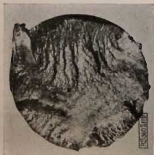
Abb. 11b. Bruchfläche eines hartgezogenen Al-Stabes. Typi- sche Dauerbruchform. 3 × vergr.
