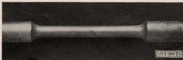
Abb. 12b. Gesamtansicht, Cu weich gegläht (Risse). 0,7 nat. Größe
