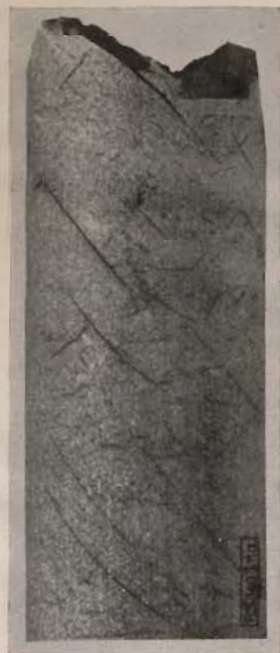
Abb. 11a. Al kalt gezogen (Risse links- und rechtsgängig). 3 × vergr.
