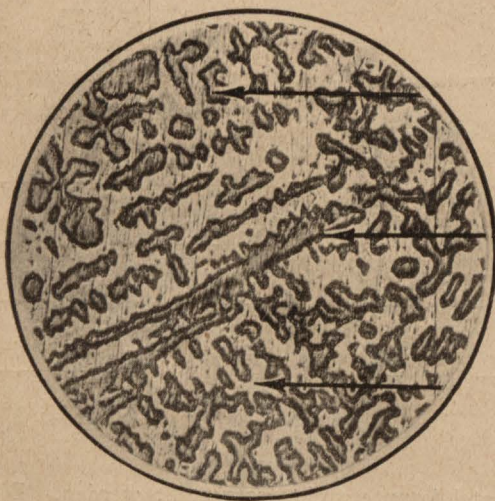
Abb. 7. Rotguß mit 4 vH Pb (Sandguß, Versuchsreihe 1), lineare Vergr. = 65.
