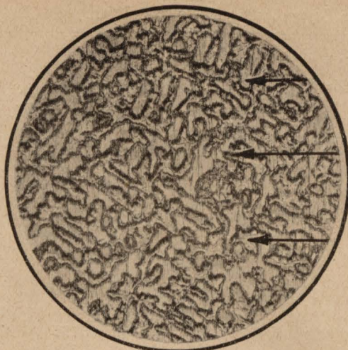
Abb. 6. Rotguß mit 1 vH Pb (Sandguß, Versuchsreihe 1), lineare Vergr. = 65.
