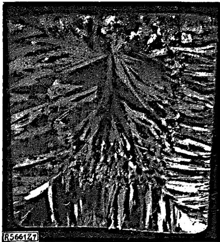
Abb. 7a. Querschnitt durch einen schlecht walzbaren, nadlig kristallisierten Kupferbarren. Geätzt mit Ammoniumpersulfat 1 : 10 (rd. \frac{2}{3} nat. Größe).
