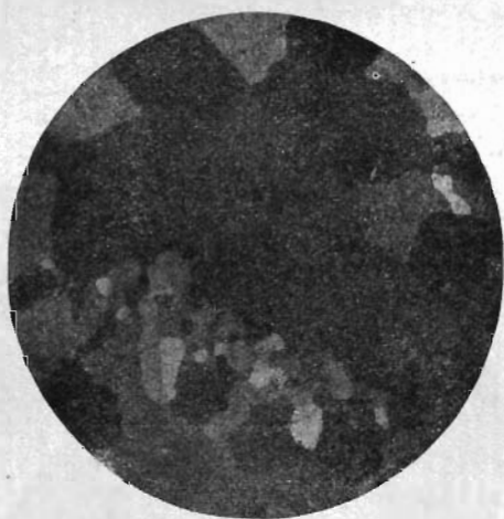
Fig. 154. Lineare Vergr. 6. Zinn mit natürlicher Gußoberfläche vor der Glühung.
