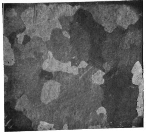
Fig. 165. Lineare Vergr. 4. Dasselbe Stück nach 20 stündigem Weiter- erwärmen bei 220°. An den Kern B haben sich ganze Kornkomplexe angegliedert.
