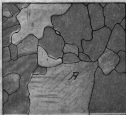
Fig. 162. Lineare Vergr. etwa 4. Gefüge eines schwach deformierten Bleies vor der Glühung.
