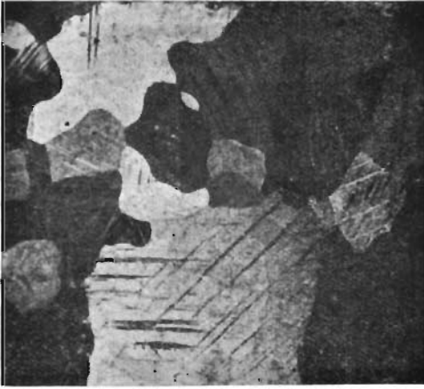
Fig. 162. Lineare Vergr. etwa 4. Gefüge eines schwach deformierten Schliffes vor der Glühung.
