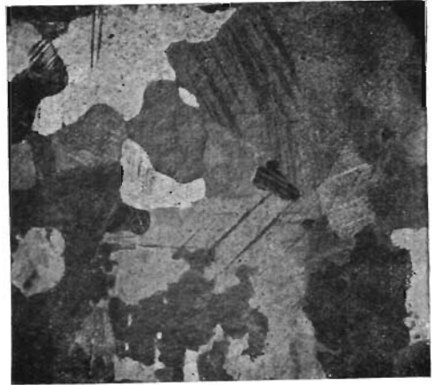
Fig. 163. Lineare Vergr. 4. Das in Fig. 162 dargestellte Metallstück nach viertelstündigem Erwärmen bei 200°. U. a. ist Kristall B neu entstanden; Korn A ist in Rekristallisation begriffen.
