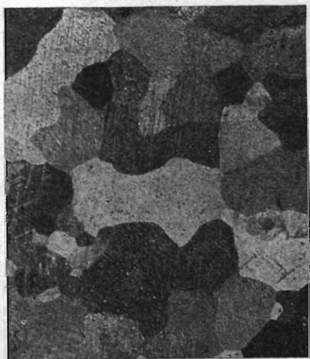
Fig. 156. Lineare Vergr. 5. Gefüge des Zinns vor dem Recken.
