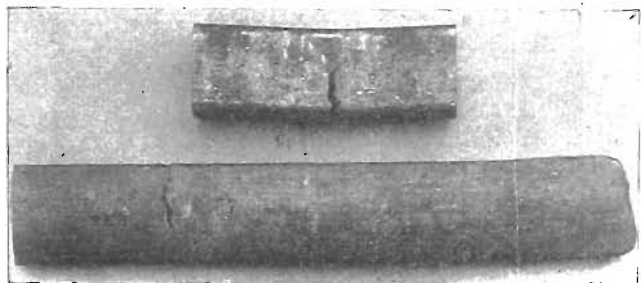
Rys. 6. Pręty miedziane, popękane przy walcowaniu (zmniejszone do \frac{1}{8} ).
