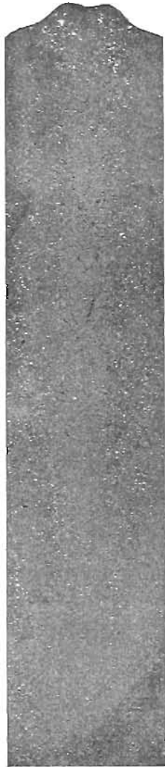
Rys. 22. Ok. 1/4 wielk. rz. Celowo odlany poprawnie blok aluminiowy, prawie bez jam. Wytraw. kwasem fluorowym i solnym.
