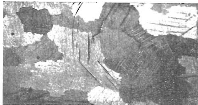
Rys. 14. Łupanie się kry ztałów cynku na zimno. Powiększenie linj. 16-krotne.
