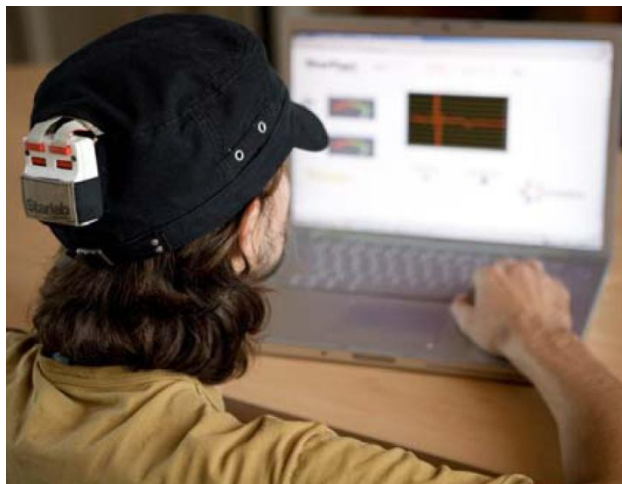
Rys 2. 3. System biometryczny firmy, rolę czepka do zbierania sygnałów pełni czapka z wbudowanymi elektrodami ENOBIO [15]
