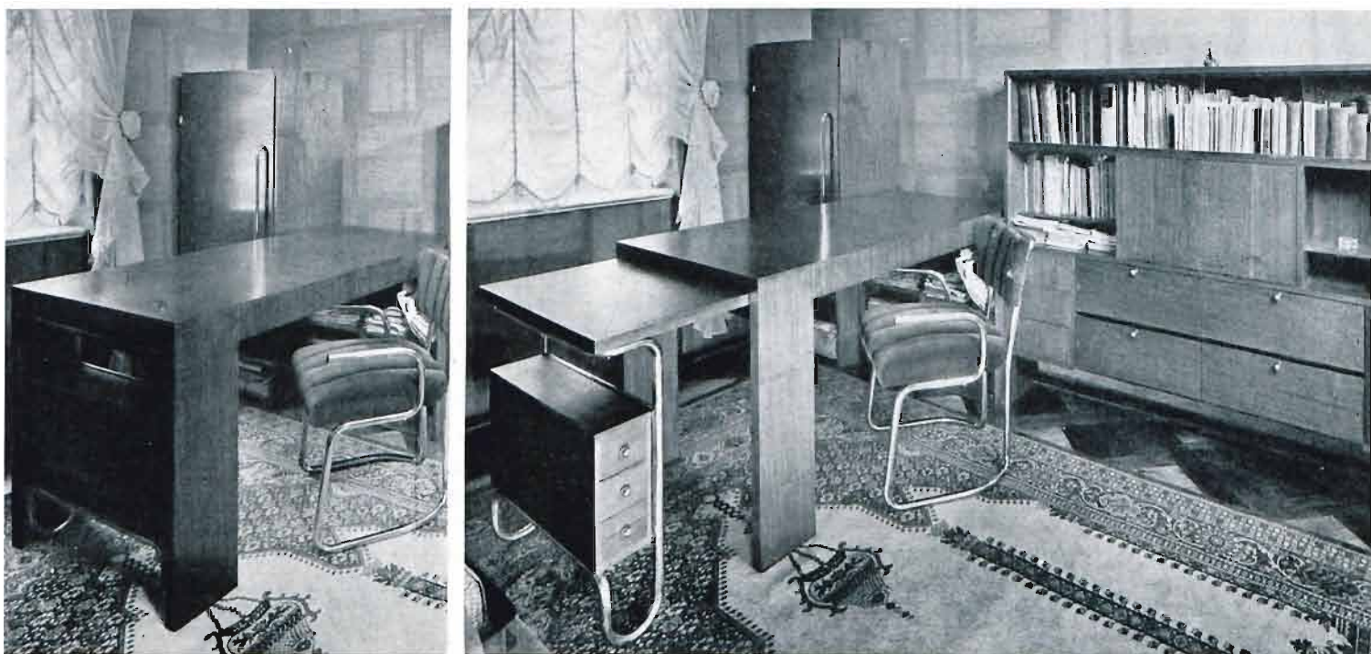
163. Proj. L. Dębnicki (W-wa). — Pokój do pracy — orzech amerykański mat. Biurko z wysuwającym stołem rysunkowym, biblioteka pośrodku z klapą na maszynę do pisania, boczne szafki z wysuwanymi półkami na rysunki. Wyk. F-ma Kamler (W-wa). Części metal. F-ma J. Puchalski (W-wa).
