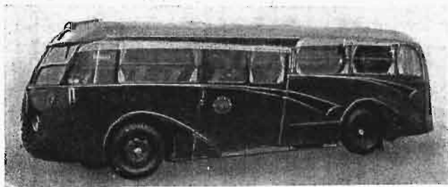
Rys. 3. Autobus o 32 miejscach z silnikiem umieszczonym z tyłu.
