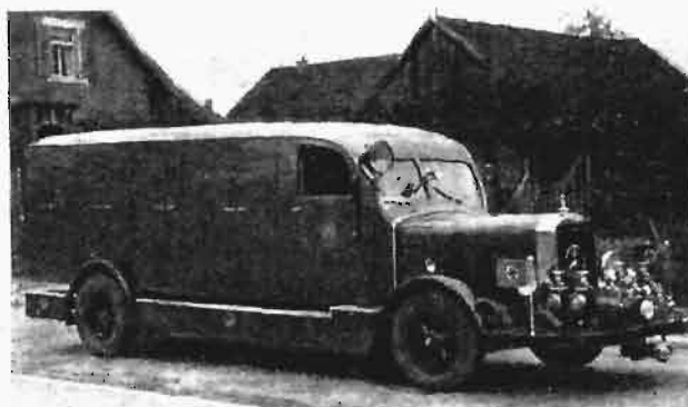
Rys. 5. Umieszczenie motopompy o wydajności 1500/min przed chłodnicą.
