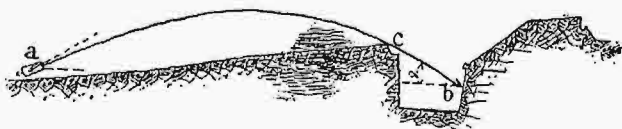
Rys. 1. Zniszczenie skarpy od pocisku przerywnego.
