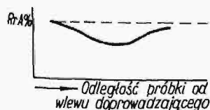
Rys. 5. Własności wytrzymałościowe staliwa w zależności od odległości od wlewu.
