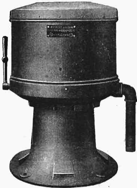
Rys. 19. Wirówka o średnicy bębna 400 mm i 980 obr./min. z silnikiem wbudowanym.
