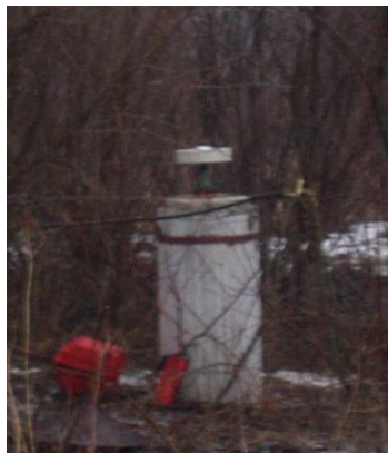
Rys. 23 Zarośnięty punkt odniesienia - zapora Besko (fot. autorki).
