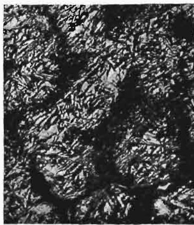
Rys. 9. Pow. 500 ×. Budowa martenzytyczna przy 8% Ni.
