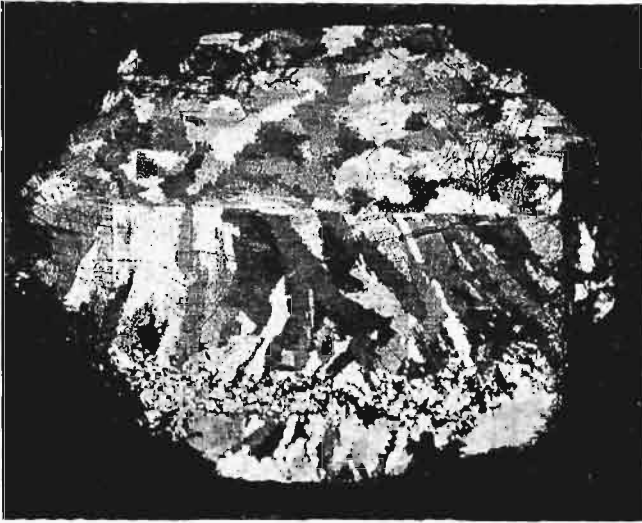
Rys. 2. Bryła antymonu — dwie przecinające się pod kątem prostym płaszczyzny, wypolerowane i trawione w (\text{NH}_4)_2 \text{Sx} . \frac{2}{3} wielkości naturalnej.
