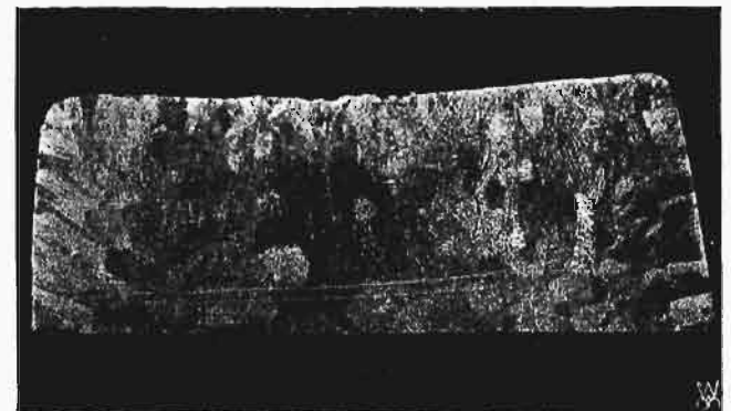
Rys. 4. Przekrój odlewu bloku o składzie 90% Sn i 10% Cu. Polerowany i trawiony w (\text{NH}_4)_2 \text{Sx} . Pow. 2 \times .
