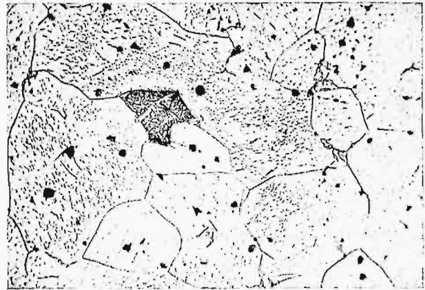
HNO 3 Rys. 11. 500 × . Po ogrzaniu do 950° C. Całkowite przekryształowanie, ziarna ferrytu mniejsze, perlit i cementyt na granicach ziarn. Azotki.
