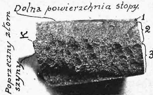
Rys. 19. Podłużne pęknięcie stopy. Wygląd złomu.
