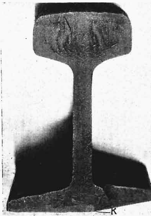
Rys. 1. Wygląd złomu poprzecznego szyny. 1:1,4
