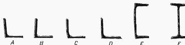
Rys. 1. Najczęściej spotykane niedokładności żelaza kształtowego.
