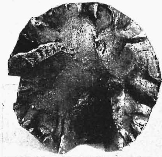
Rys. 10. 1:2. Wygląd złomu wału II (Ø 155 mm).
