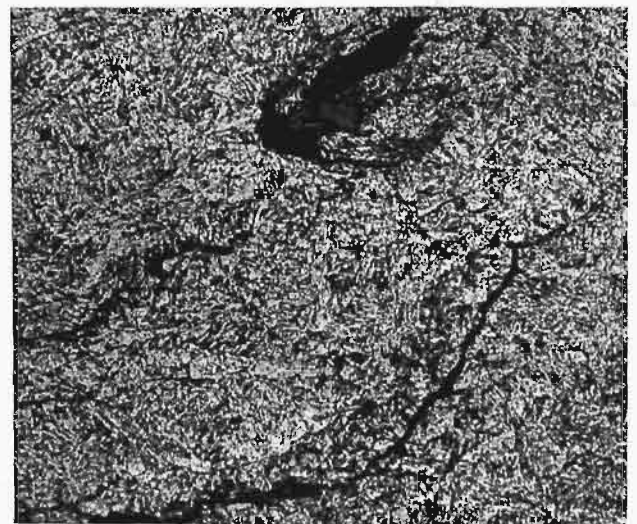
Rys. 16. Pow. 200 X. Ryski mikroskopowe w warstwie napawanej.
