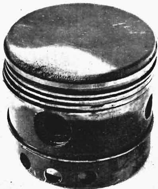
Rys. 1. Widok uszkodzeń denki tłoka, spowodowanych przez spalanie detonacyjne paliwa.
