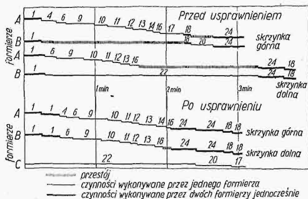
Rys. 4. Harmonogram formowania maszynowego jednego z modeli w odlewni staliwa.
