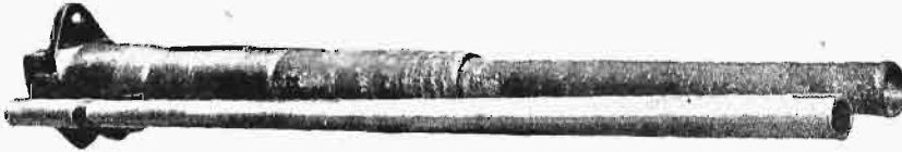
Rys. 1. Lufa armaty 3" przeciwlotniczej, długości 3,5 m, z wymienną duszą.
