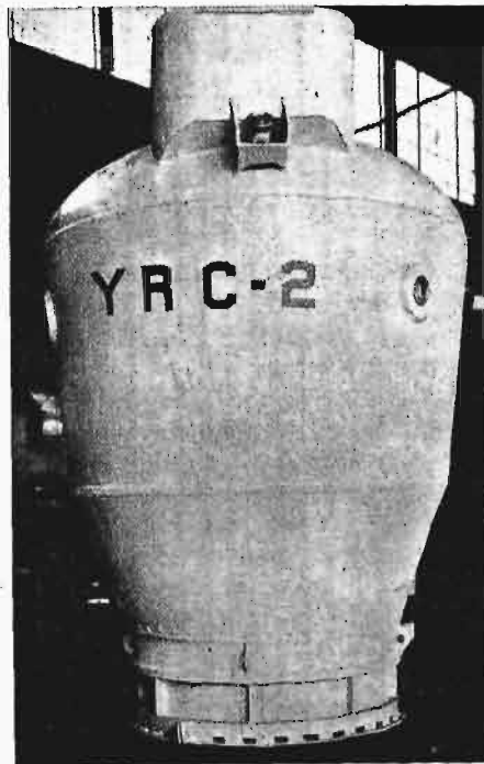
Rys. 7. Całkowicie spawana komora do ratowania załogi zatopionych łodzi podwodnych.
