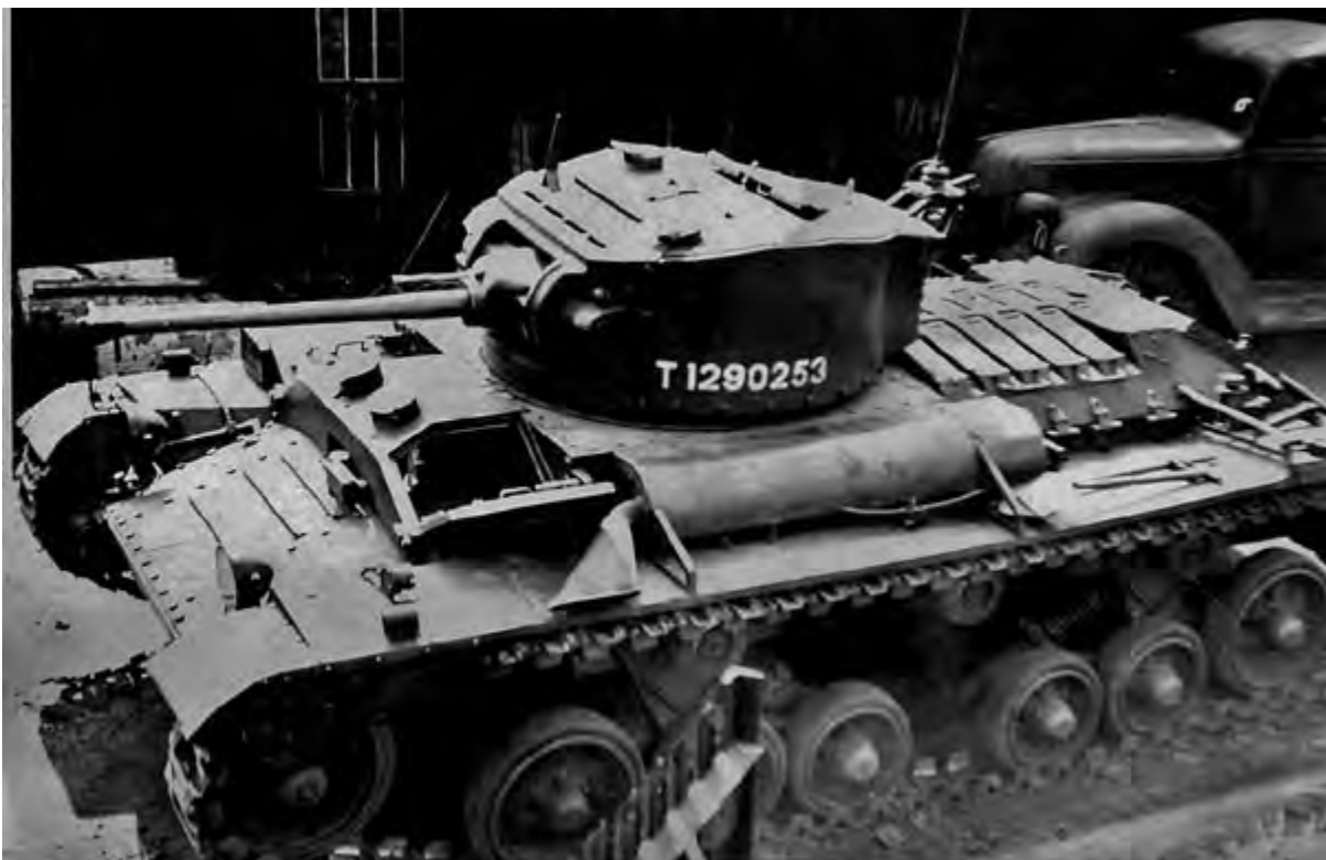
Fot. 100. Czołg VALENTINE w naprawie. Widać szczegóły budowy nitowanego kadłuba i wieży
