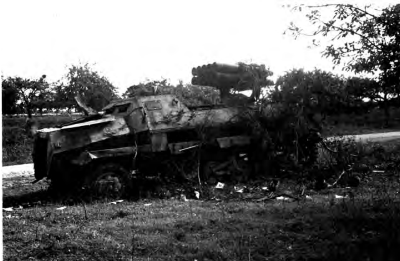
Fot. 125. Wrak zniszczonej niemieckiej samobieźnej półgąsienicowej 10-cio lufowej wyrzutni raketowej Panzerwerfer 42 kal. 150 mm
