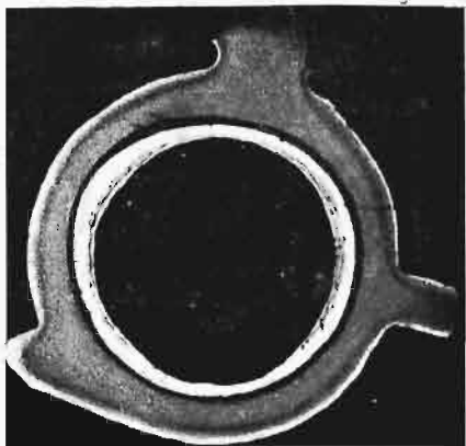
Rys. 13. Odczynnik Anczyca I. \times 1 .
