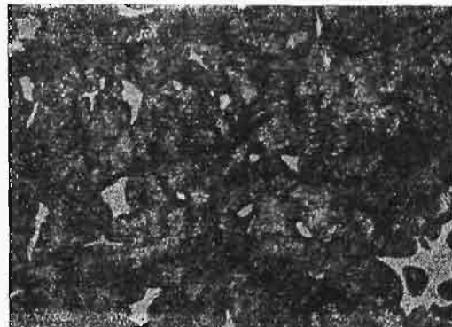
Rys. 8. Zbiornik pary Żeliwo perlityczne zwykłe p/g Kuehnel'a i Nesemann'a. (X 100).
