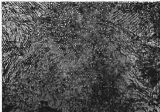
Rys. 1. Obraz perlitu w żelazie podług Goerens'a. (X 500).
