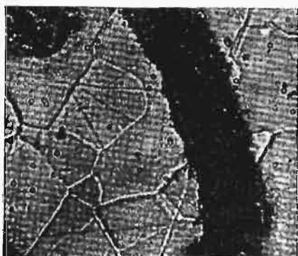
Rys. 3. Bardzo miękkie żeliwo ferrytyczne p/g Wuest'a. (X800).
