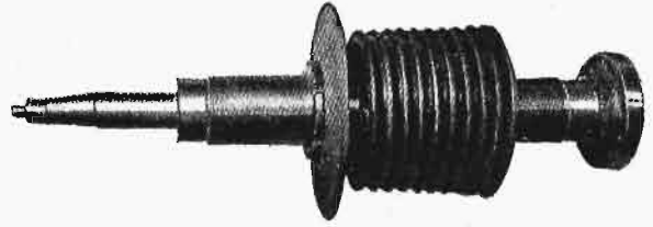
Rys. 6. Wirnik wysokoprężny turbiny z rys. 5.
