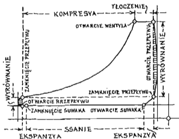
Rys. 10. Schematyczny wykres kompresora z wyrównaniem ciśnień.
