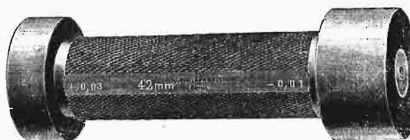
Rys. 6 i 6a. Kalibry tolerancyjne (sprawdziany graniczne).
