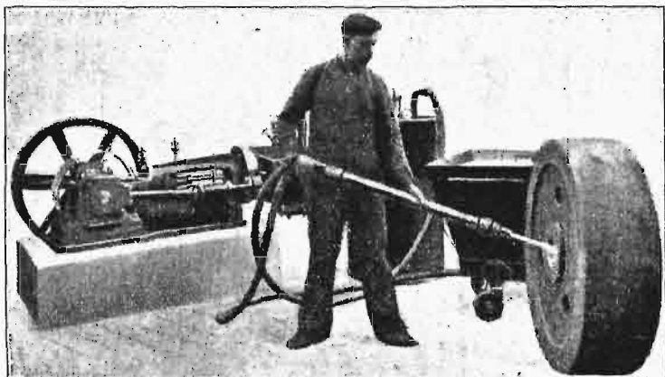
Rys. 1. Przenośna piaskownica wydmuchowa. (Kompresor i powietrznik z przesuwaną skrzynką do piasku).
