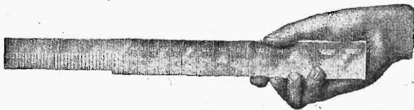
Rys. 3. Zjawisko przywierania szeregu klocków mierniczych.
