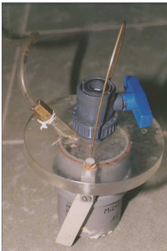
Fot. 5. Aparat do badań przepuszczalności hydraulicznej z próbką zawiesiny twardniejącej podczas badania (Kledyński i inni, 2004)
