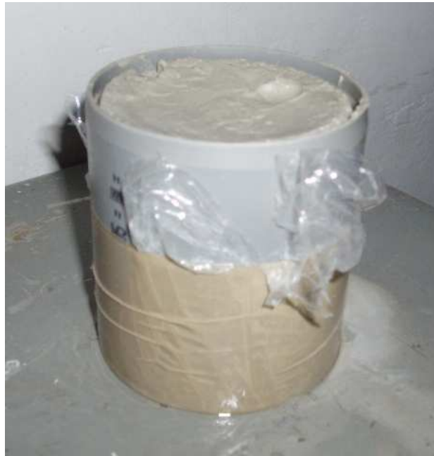
Fot. 5. Próbkę zawiesiny twardniejącej w formie plastikowej przeznaczoną do badania przepuszczalności hydraulicznej
