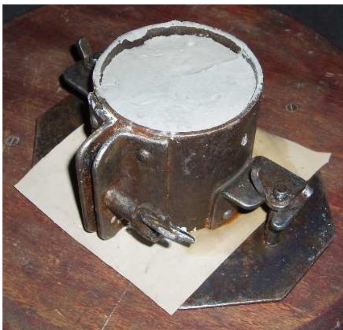
Fot. 4. Próbką zawiesiny twardniejącej w formie metalowej
