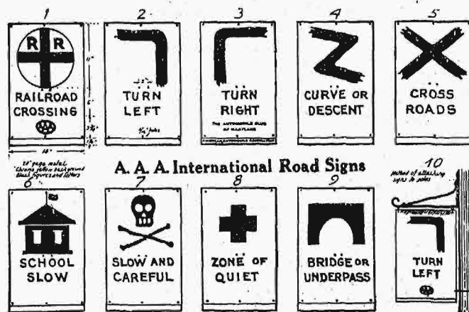
Rys. 57. Tablice ostrzegawcze budowane przez Stowarzyszenie Amerykańskich Automobilistów i rozstawiane na różnych drogach pozamiejskich.
