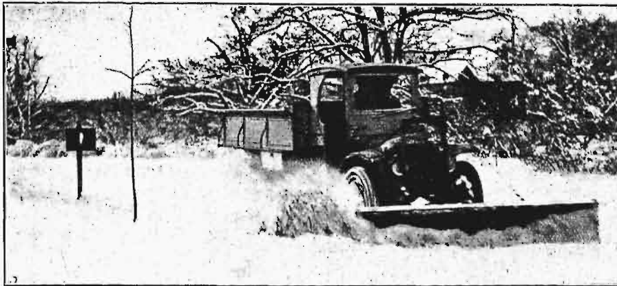
Rys. 53. Samochód ciężarowy, zaopatrzony w pług i szczotkę, używany do usuwania śniegu z ulic i dróg pozamiejskich.
