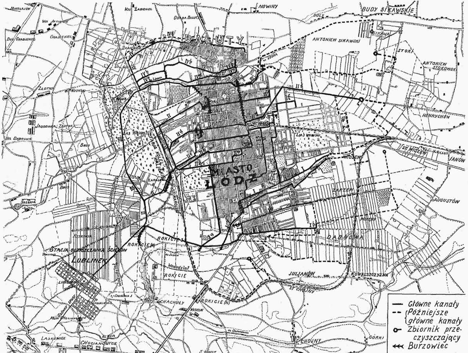
Rys. 2. Projekt sieci kanalizacyjnej.
