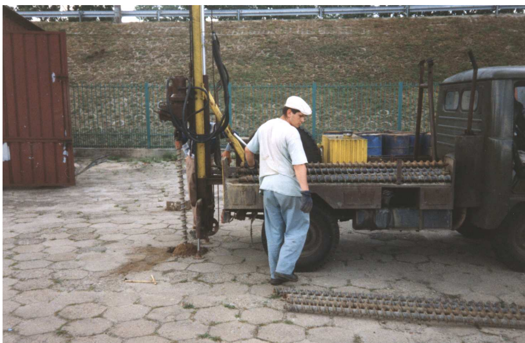
Rys. 8.8 Wiertnica mechaniczna na podwoziu samochodowym w trakcie wykonywania drugiego odwiertu
