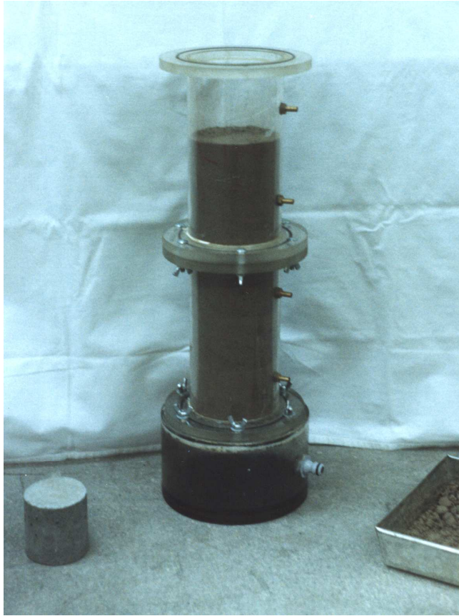
Rys. 8.12 Wypełnianie odcinka pomiarowego etap 4
