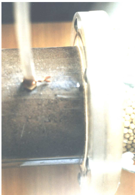
Rys. 8.22. Trzeci wariant doświadczenia. Stery rozluźnienia gruntu powstałe na kontakcie z gruntem o większej porowatości
