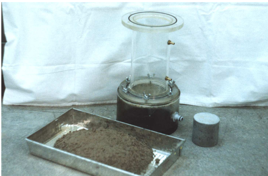
Rys. 8.9 Wypełnianie odcinka pomiarowego etap 1
