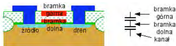
Rys. 9.11. Dwubramkowy tranzystor nMOS stosowany w reprogramowalnych pamięciach ROM
