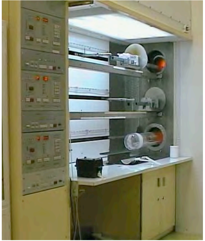
Doświadczalna linia produkcyjna Instytutu Technologii Elektronowej w Piasecznie pod Warszawą: po lewej pracownia fotolitografii, po prawej piece, w których wykonuje się operacje wysokotemperaturowe.
