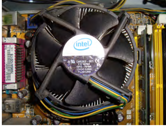
Fragment wnętrza komputera, około roku 2005 - bezpośredni nadmuchi powietrza na radiator umocowany na procesorze. Częstotliwość zegara: 2 GHz.
