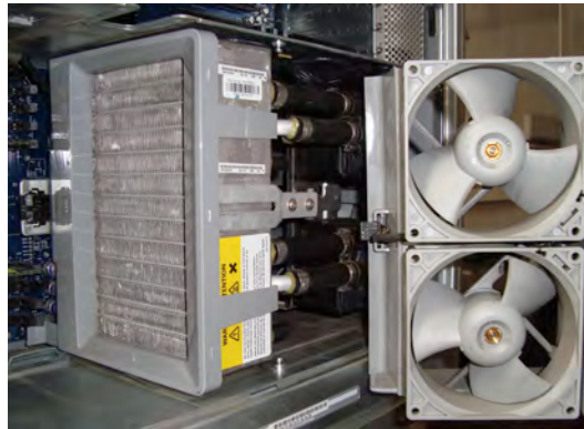
Fragment wnętrza komputera, około roku 2008 - moduł chłodzenia cieczą zespołu procesorów, obok (wyjęty do zdjęcia) zespół dwóch dmuchaw. Częstotliwość zegara: 2,7 GHz.
