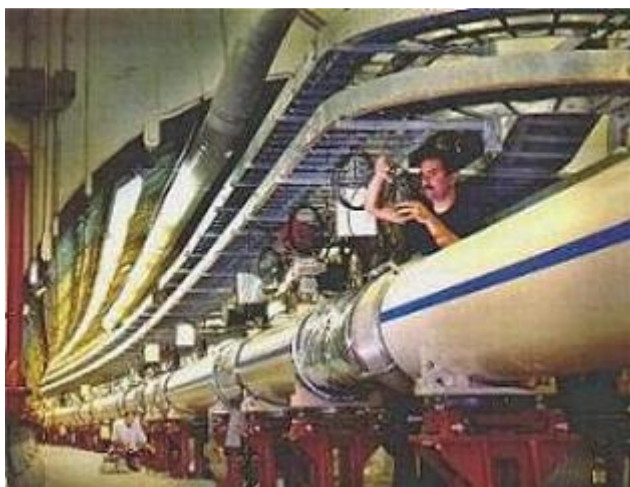
Fot. 4.0.1 W jonowodzie zderzacza RHIC w Brookhaven poruszają się w dwóch przeciwnych kierunkach jony złota z prędkością równą 0.99996 prędkości światła.
