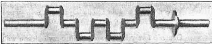
Rys. 1. Wał korbowy do samojazdu trudny do wykonania.
