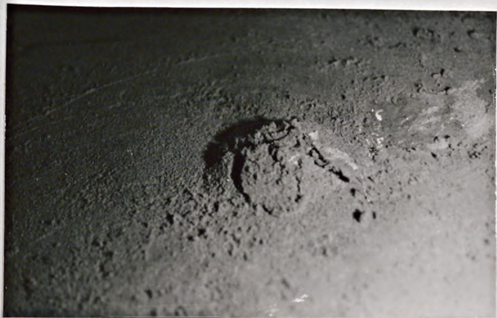
Rys. 6.8. Zarys bryły odporu na powierzchni gruntu.
