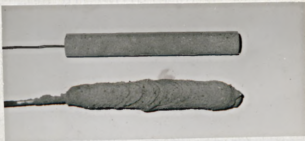
Rys. 5.3. Buławy: a) prefabrykowana, b) iniektowana
