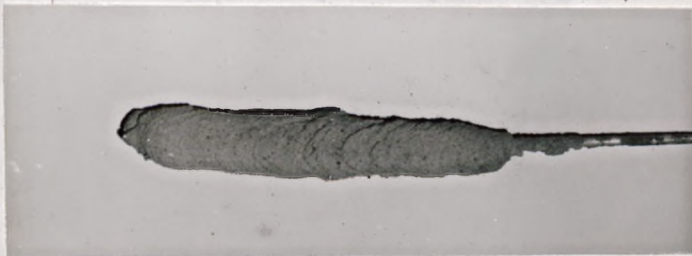
Rys. 6.22. Buława formowana w gruncie metodą iniekcji.
